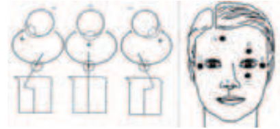
Figura 1. Comportamiento del ojo humano como dipolo (derecha) y ubicación de electrodos para el análisis EOG (izquierda). Los electrodos B y C toman la señal vertical, los electrodos D y E toman la señal horizontal y el electrodo A sirve de referencia. Imagen tomada de [1]
